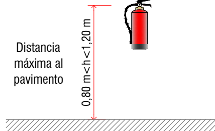
D1 Detalle de colocación de Extintor - Altura mínima Extintores de ABC/CO 2
