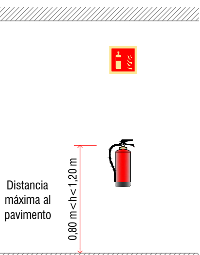
D1 Detalle colocación extintor Escala: s/e
