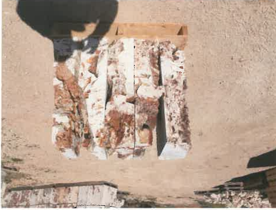
Figuras 34 y 35. Ejemplos del gran desarrollo del karst en las facies del Complejo Arrecifal y el alto grado de alteración de la roca. Este aspecto corrobora el riesgo de colapso y hundimiento derivado de cualquier actividad constructiva sobre las urbanizaciones de Cala Pi, Es Pas y Vallgornera.
